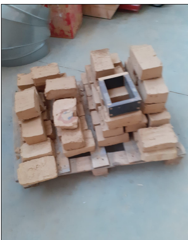
Construction de mur en briques de terre & paille (3è Habitat)
