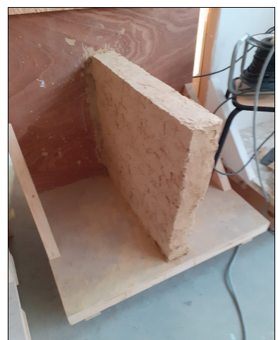
Construction de mur en briques de terre & paille (3è Habitat)
